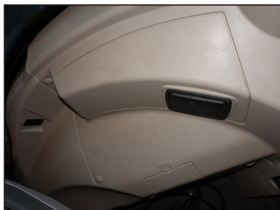
Abb. 12: Seitenverkleidung des Sicherungskastens
