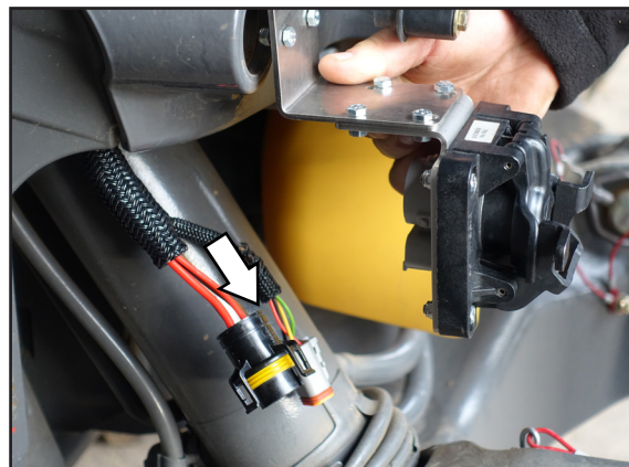
Abb. 21: ISOBUS-Kabelsatz zwischen Hydraulikzylinder und Frontplatte zur Frontsteckdose führen
