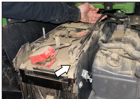
Abb. 20: Masseanschluss an Batterie angeschlossen
