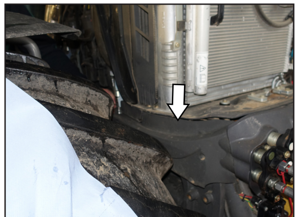
Abb. 9: Verkleidung vorne rechts an Motorhaube entfernen
