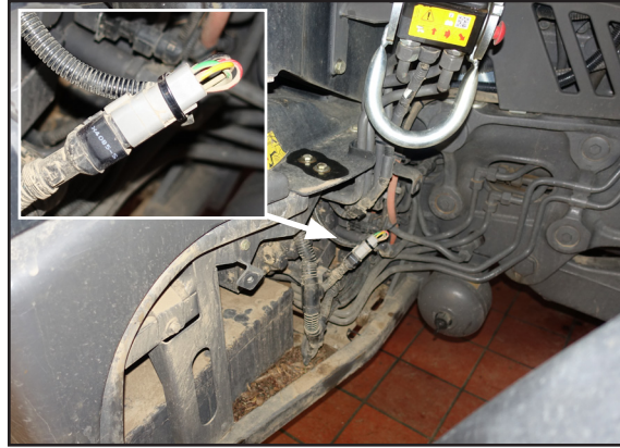
Abb. 18: ISOBUS-Hauptkabelsatz mit Stecker X4085 des Fahrzeugs verbunden
