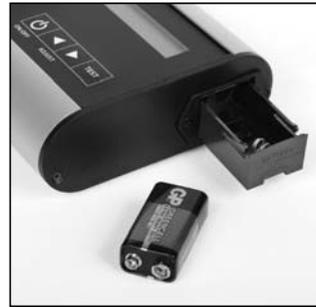
Abbildung 1. Batteriefach
